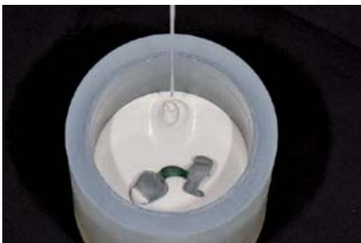
Éviter la formation de bulles d'air lors du remplissage du cylindre avec le revêtement.
