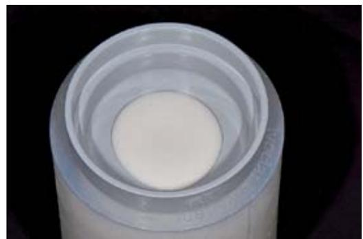
Placer le capuchon du cylindre au sommet du cylindre pour maintenir le parallélisme des surfaces supérieure et inférieure.
