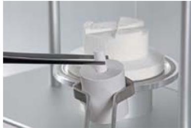
Placer ensuite le piston à usage unique dans le cylindre de revêtement chaud.
