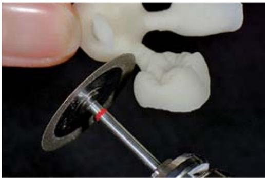
Utiliser des disques diamantés fins à faible vitesse pour couper les tiges de coulée.
