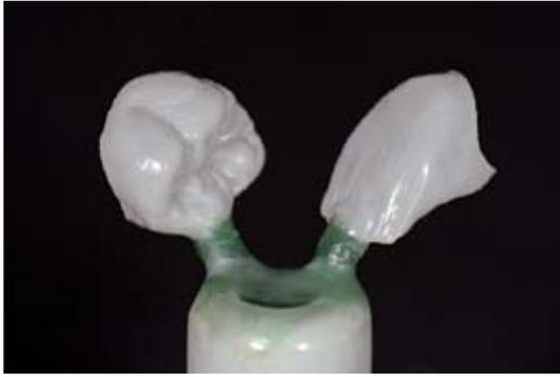
Fixer les objets dans le sens d'écoulement de la céramique et sur l'endroit le plus épais du modèle en cire.
