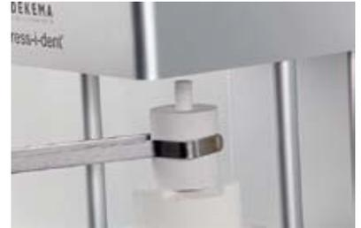
Placer le cylindre de revêtement complet au centre du four de pressée préchauffé.
