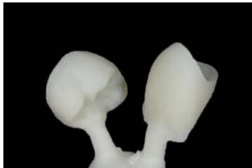
Objets entièrement dégagés après le dégagement fin avec de l' $\text{Al}_2\text{O}_3$  à une pression d'environ 0,1-0,2 MPa (1-2 bars).
